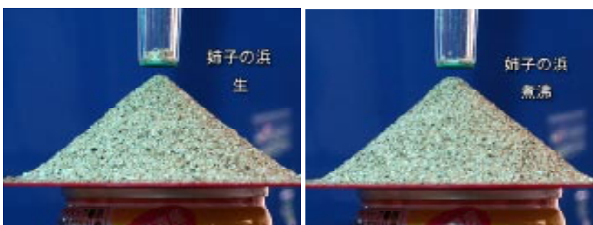
写真 6-4. 姉子の浜の砂安息角
