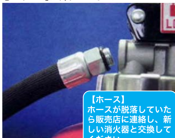
ホースの脱落
