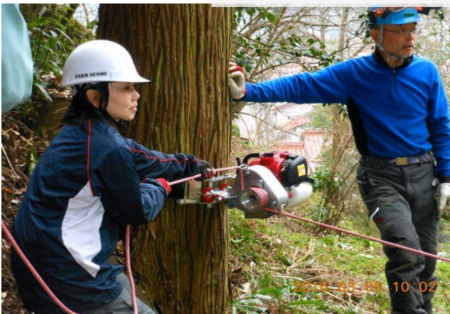
エンジンロープウィンチで重たい木を引っ張る技
